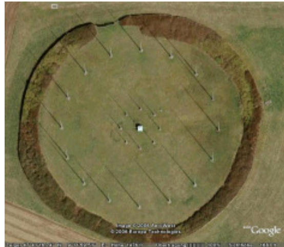
Abb. 2 und 3: Die Funkkontroll-Messstelle Konstanz der Bundesnetzagentur aus der Luft: Betriebsgebäude mit Log-Periodic (links) und Kreispeiler (rechtes Bild) - Quelle: Google-Earth
